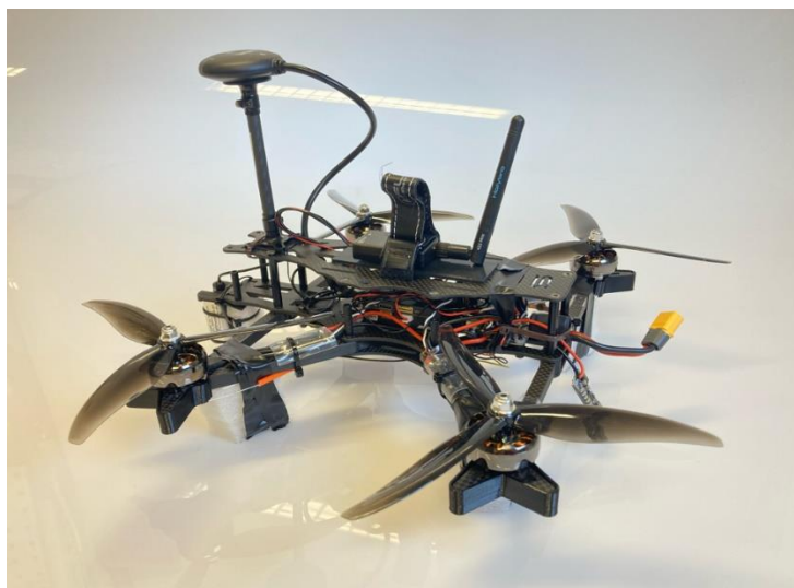
Figur 8. ZPV:n med sensorer. Omborrdatorn kommer att monteras på ovensidan. Foto: FOI.
